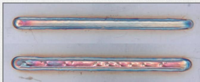
Comparaison de la « régulation analogique des gaz » (en bas) et de la « régulation numérique des gaz OTC » (en haut).
