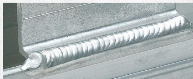
Courant de soudage 130 A, fréquence AC 150 Hz, vitesse 25 cm/min, épaisseur de tôle 3 mm
