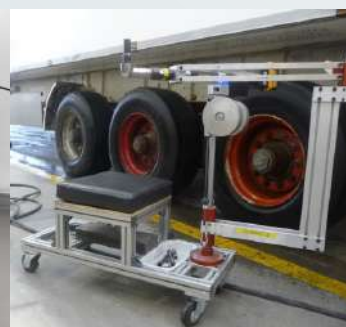
Poste de travail mobile pour serrage sous caisse camion (couple 75 Nm) DOC.40662
