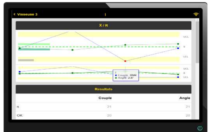
Visualisation du dernier vissage et stockage des résultats pour analyse
