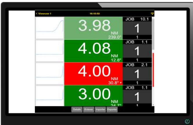
Visualisation du dernier vissage et stockage des résultats pour analyse
