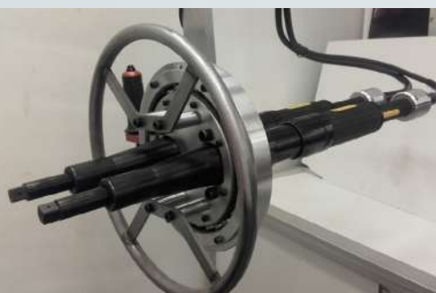
Bi-broches pour serrage de roues (couple 105 Nm, entraxe 100 mm) DOC.40453
